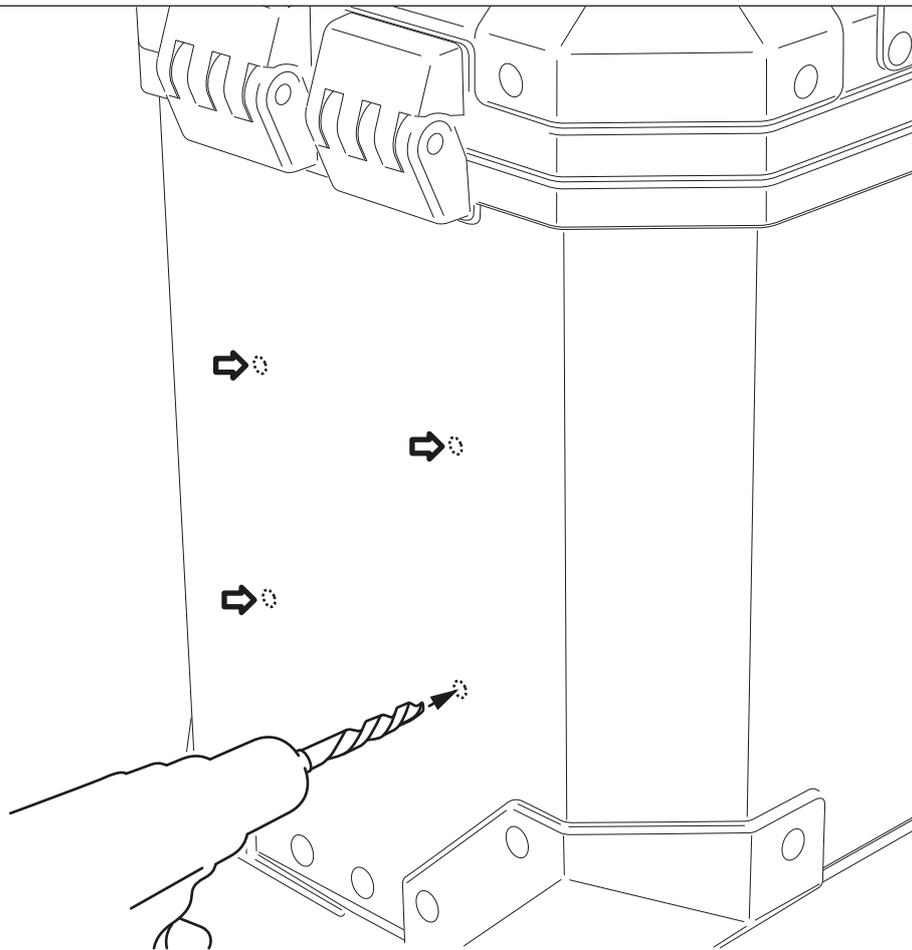
Nutzen Sie einen 5,5-mm-Bohrer, um das Gehäuse des Koffers an den markierten Stellen aufzubohren. Entkraten Sie anschließend die Ränder der Bohrlöcher (ALU-BOX Beispielabbildung).
