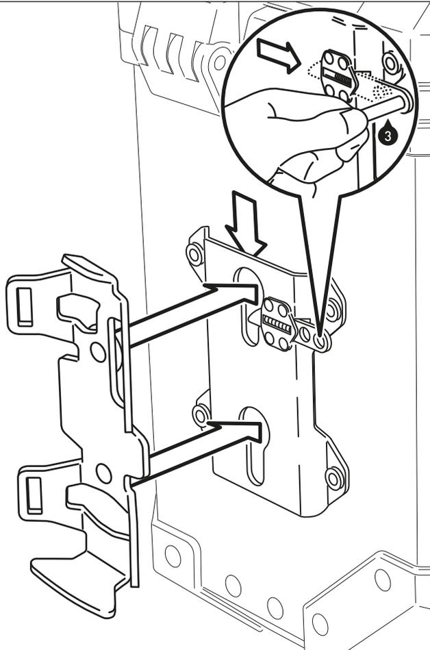
Setzen Sie nun das von Ihnen gewählte Halteblech in den Universal-Halter (1) ein. Drücken Sie das Halteblech nach unten, bis dieses sicher einrastet. Nutzen Sie den beiliegenden Bolzen (3), um den Riegel wieder zu lösen, wie im Detailzeichnung gezeigt (ALU-BOX Beispielabbildung).
