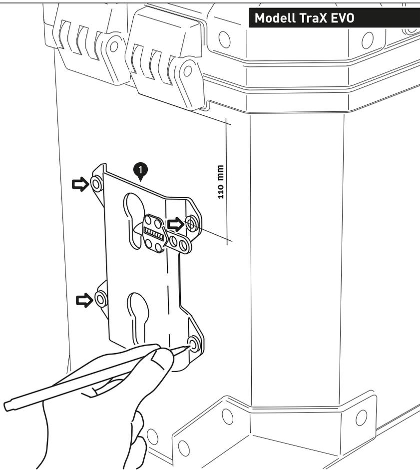
Legen Sie den Universal-Halter (1) auf das Gehäuse des Koffers. Markieren Sie mit einem wasserlöslichen Marker die vier Bohrungen, wie in der Zeichnung gezeigt.
