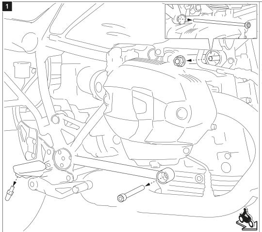
Entfernen Sie die gezeigte Schraube, Mutter und Schräglagenbegrenzer auf der rechten Fahrzeugseite.
