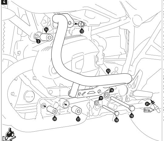
Verschrauben Sie den linken Schutzbügel (12), wie in der Zeichnung gezeigt. ACHTUNG: Verwenden Sie flüssige
