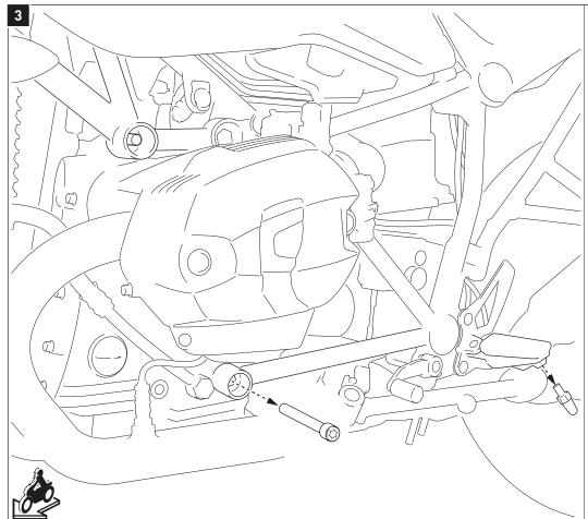
Entfernen Sie die gezeigte Schraube und den Schräglagenbegrenzer auf der linken Fahrzeugseite.
