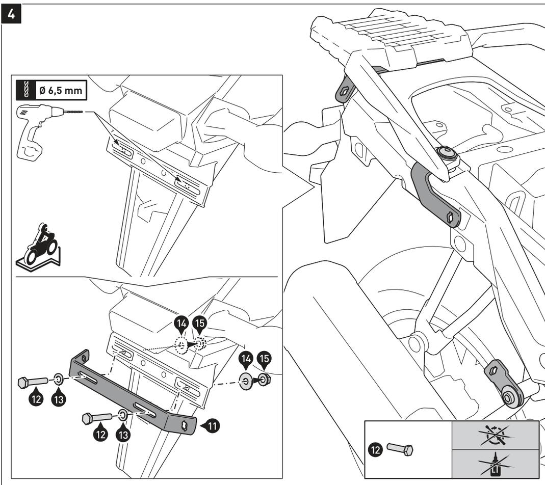
Bohren Sie mit einem 6,5-mm-Bohrer in der Mitte der Vertiefungen des Kennzeichenhalters die Befestigungsbohrungen des Querverbinders (11), wie in der Zeichnung gezeigt. Entgraten Sie anschließend die Ränder der Befestigungsbohrungen.
