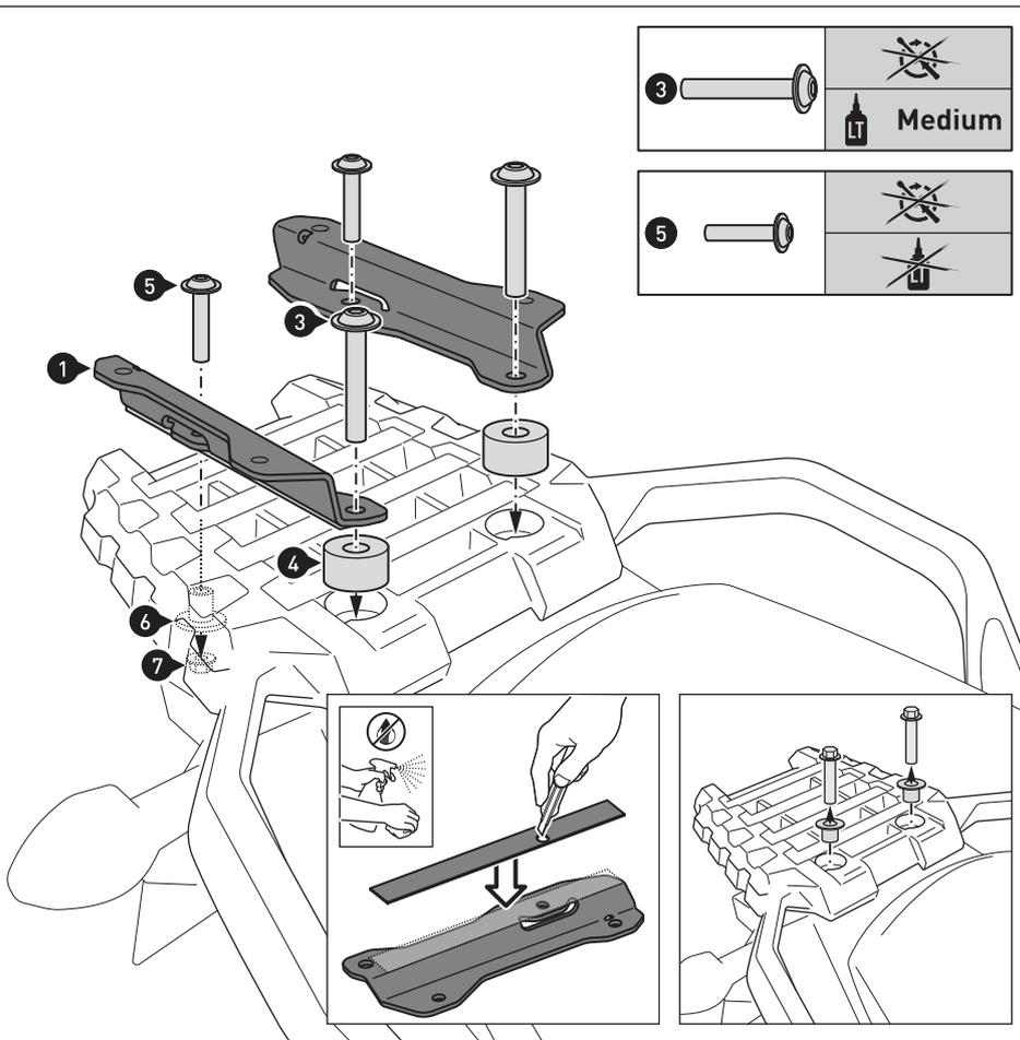
Reinigen Sie die Oberfläche der Anbaubleche (1) und verkleben Sie die Schonstreifen (2) auf deren Unterseite, wie in der linken Detailzeichnung gezeigt.
