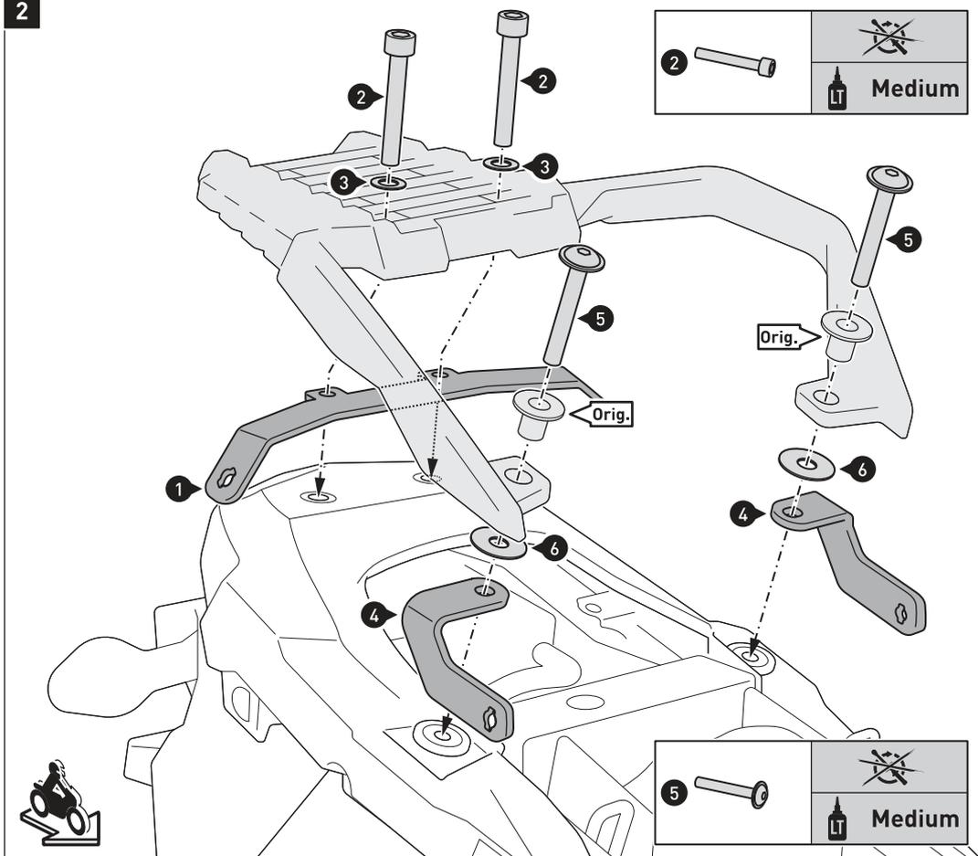
Verschrauben Sie den Querverbinder (1) und die Befestigungslaschen (4) mit den original Bundbuchsen (Orig.) und Gepäckträger am Fahrzeug, wie in der Zeichnung gezeigt.
