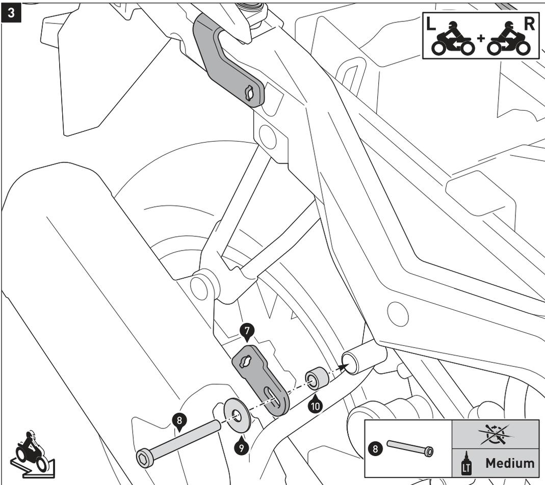
Verschrauben Sie die Befestigungslaschen (7) an den Sozius-Fußrastenhaltern, wie in der Zeichnung gezeigt. Ziehen Sie die Schrauben noch nicht an.
