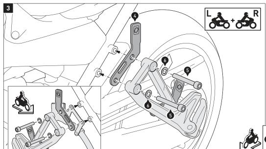
Verschrauben Sie die Befestigungslaschen (4) **beidseitig** mit den Soziusfußrastenhaltern am Fahrzeug. *HINWEIS: Verschrauben Sie rechts*
