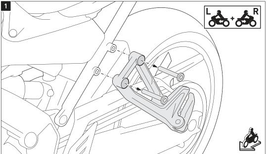
Entfernen Sie die gezeigten Schrauben **beidseitig** von den Soziusfußrastenhaltern.
