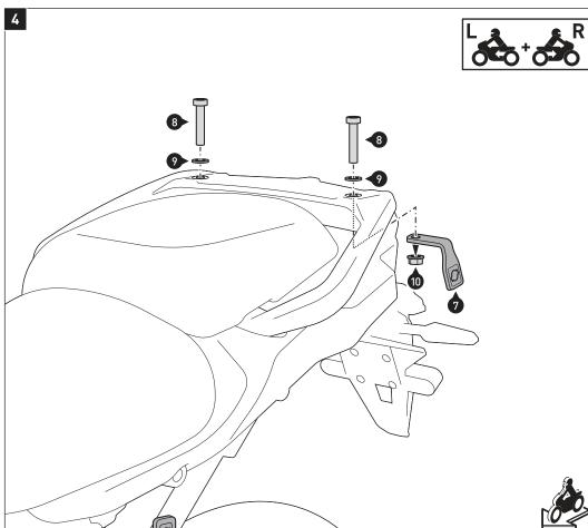
HINWEIS: Wenn der Seitenträger mit dem SW-MOTECH Gepäckträger montiert wird, entfallen die Schrauben (8). Verwenden Sie stattdessen die Schrauben des Gepäckträgers.
